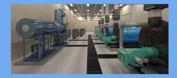
(4) 11,700 MBH STEAM BOILERS LOW NOX BURNER & BOILER STACK ECONOMIZER (3) STEAM TO WATER HEAT EXCHANGER **STEAM FOR HUMIDIFICATION & STERILE EQUIPMENT** PROVIDES 140°F TO AHUS AND CAVS
